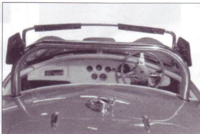
Fig.10a. Roll-over bar fitted.
